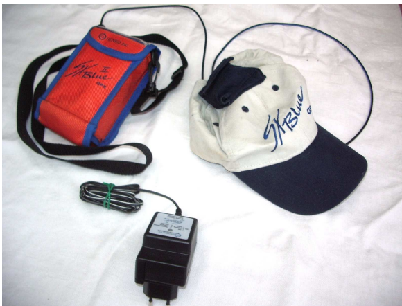
Ensemble antenne - GPS et cordon secteur
